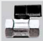
Absperrentil/ Kugelhahn Dichtung aus PTFE Teflon, beidseitiges Innengewinde 1/2", messing vernickelt.
